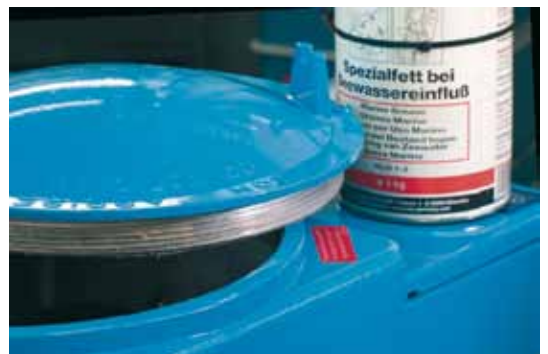
Bild 9: Verwendung von korrosionshemmenden Fett
