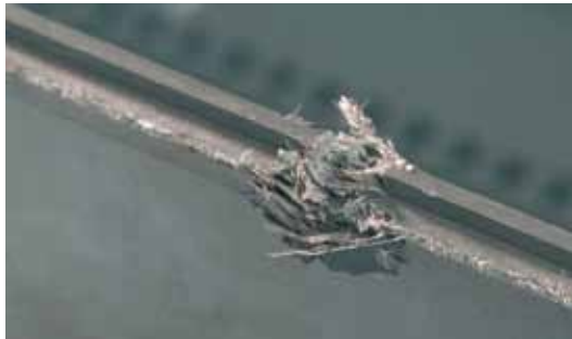
Bild 12: Beispiel für Beschädigungen der Dichtlippe von Gehäusen
