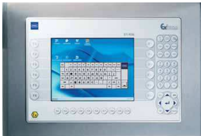
Bild 4: Über eine Abpufferung an allen vier Ecken des Edelstahlgehäuses werden die schiffstypischen Vibrationen abgemildert, um die Elektronik des HMI zu schonen.
