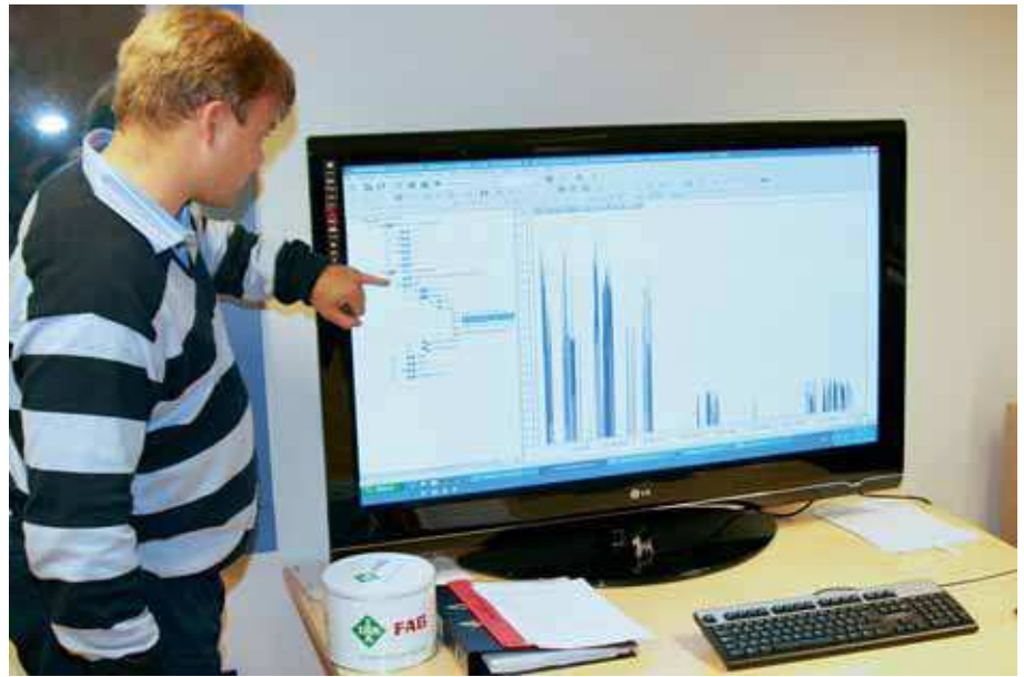
Bild 7: Online-Auswertung von Schwingungsmessungen zur vorbeugenden Wartung
