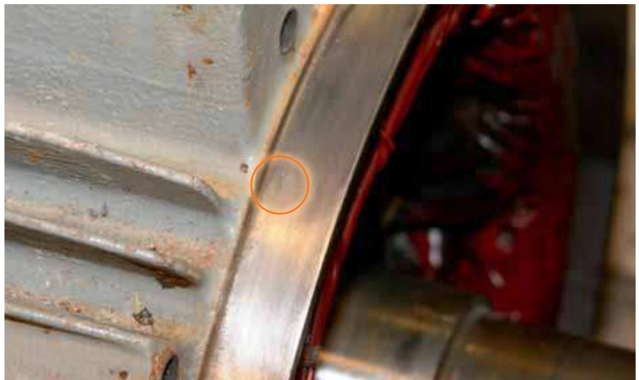
Bild 1: Beschädigung des d-Spaltes an einem druckfestgekapselten Motor vor der Reparatur
