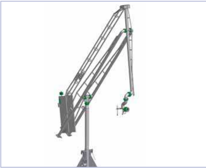
Bild 3: Symmetrischer Aufbau eines Verladearms
