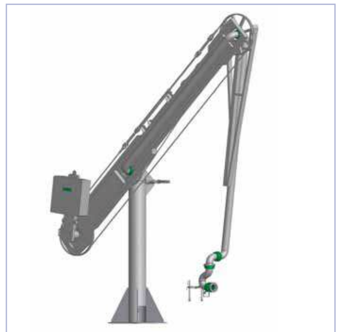
Bild 2: Bewegliches Gegengewicht am Verladearm
