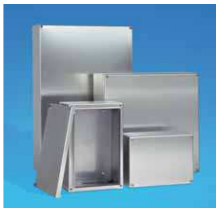
Bild 2: Langlebige Lösung: Neue Stahlblechgehäuse in der Zündschutzart Erhöhte Sicherheit >e<. Eindringendes Wasser läuft in einer Rinne unterhalb des Deckels ab, um es von Dichtungsmaterial fernzuhalten.
