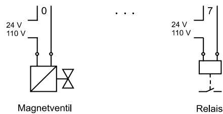
Abb. 7-18 Digital Output Modul Relais Typ 9477 (anschließbare Feldgerät-Typen)
